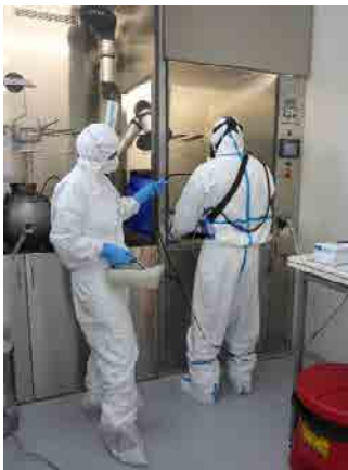
Figure 1 : (a - à gauche) Mesure des concentrations en nombre de particules à proximité de l'opérateur et en fond au cours d'essais d'explosivité de NC et de NTC (Source : ISSeP) ; (b - à droite) Agglomérat de NC prélevé sur une grille MPS analysée par MET (Source : INERIS).
