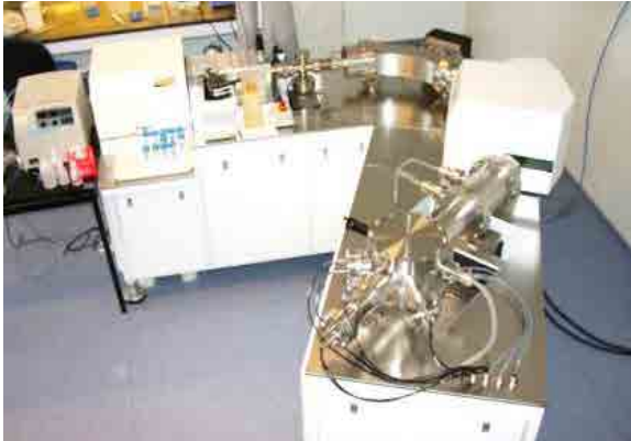
Figure 1 : Analyse de la composition isotopique du Pb par MC-ICP-MS (MC-ICP-MS Nu plasma, G-TIME, ULB)
