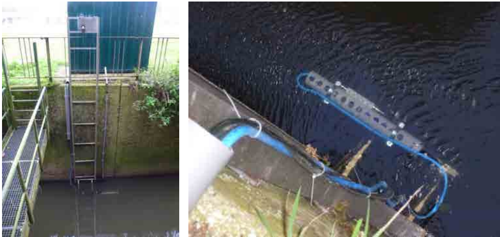
Figure 3 : (A) Station de mesure sédimentologique de la Samme à Ronquières (B) Mesure de la turbidité et échantillonnage automatique
