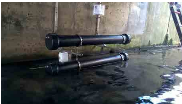
Figure 3 : Déploiement d'échantillonneurs passif de type silicone rubber (SSP-M823) sur la Meuse à Visé
