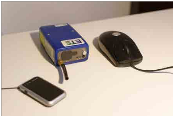
Figure 1 : De gauche à droite, GPS Globalsat DG200, analyseur de BC AethLabs AE51 et souris d'ordinateur pour donner une idée de la taille des instruments
