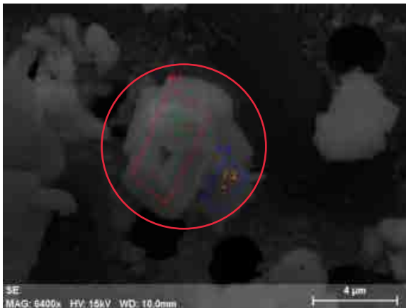
Figure 1a : Image en SEM/EDX d'un gypse anthropique massif > 4\mu m , (Ca, Sr)(SO_4, HPO_4) \cdot 2H_2O
