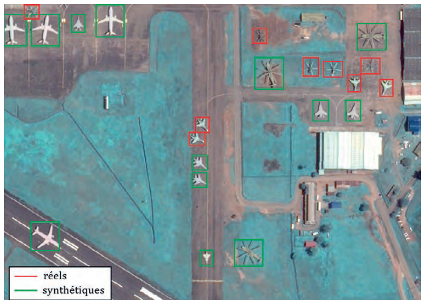
Image synthétique montrant des avions et hélicoptères réels (en rouge) et rajoutés (en vert) sur une image Pléiades de l'aéroport d'Entebbe (Ouganda)
